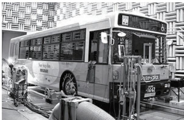
写真1 大型C/Dによる排出ガス計測
