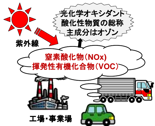
図1 光化学オキシダント発生メカニズム
