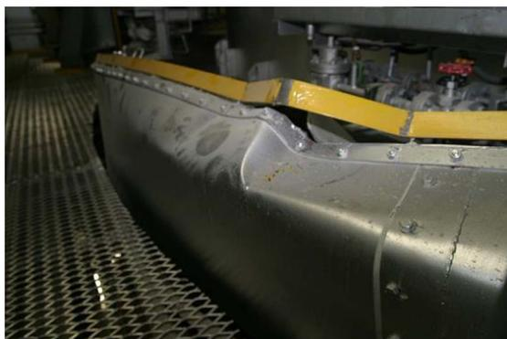
写真4 破損した2号溶融炉(2004年1月)
