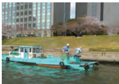
コンベア船での清掃作業
