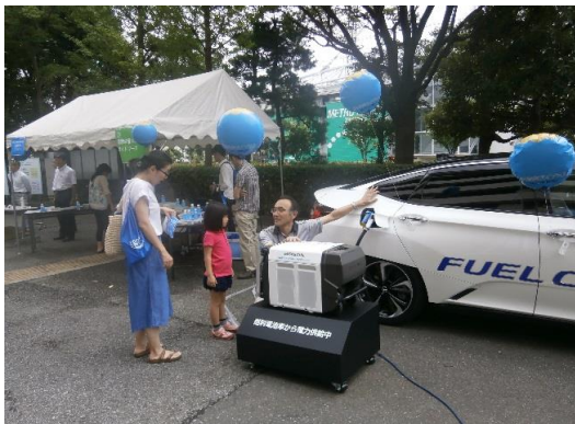
燃料電池自動車（FCV）と外部給電設備
